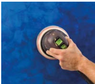
Polieren mit Festool Getriebe-Exzenter Schleifer Rotex RO 150 FEQ. Alternativ kann manuell mit der Spachtel poliert werden.
