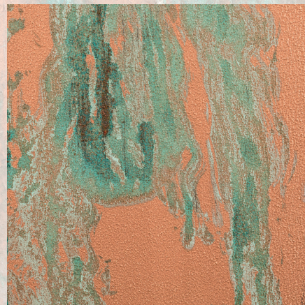
ca. 30 Minuten warten bis der Grünspan sichtbar wird.
