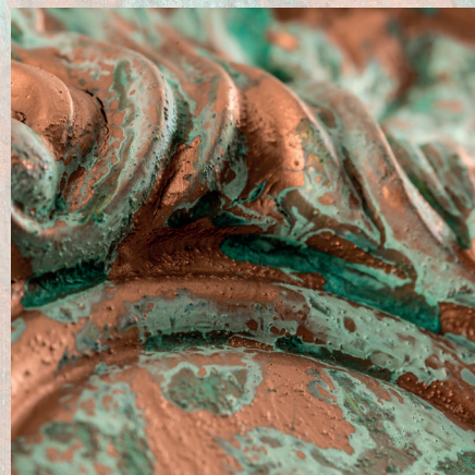
ca. 30 Minuten warten bis der Grünspan sichtbar wird.
